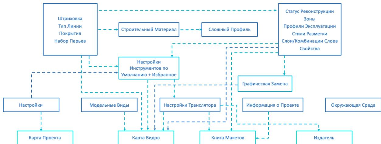
Рис. 13: Структура рабочей среды проекта в ARCHICAD
